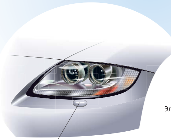
Сложная оптическая система с автоматическим контролем уровня и мощной очищающей системой
